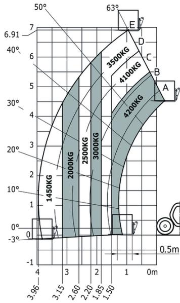
Machine sur pneus avec fourches Impérial
